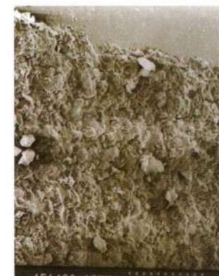
شکل ۱-۱۰ نمایی با میکروسکوب الکترونی از سطح اسپری شده با تیتانیوم (TPS) در ایمپلنت های اولیه استرامان.
