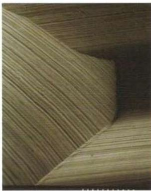
شکل ۱-۷ نمایی با میکروسکوب الکترونی از سطح ماشینکاری شده ایمپلنت. برستگی ها و شیارها در سطح این ایمپلنت پرتوارک در طی عملیات ماشینکاری ایجاد شده است.
