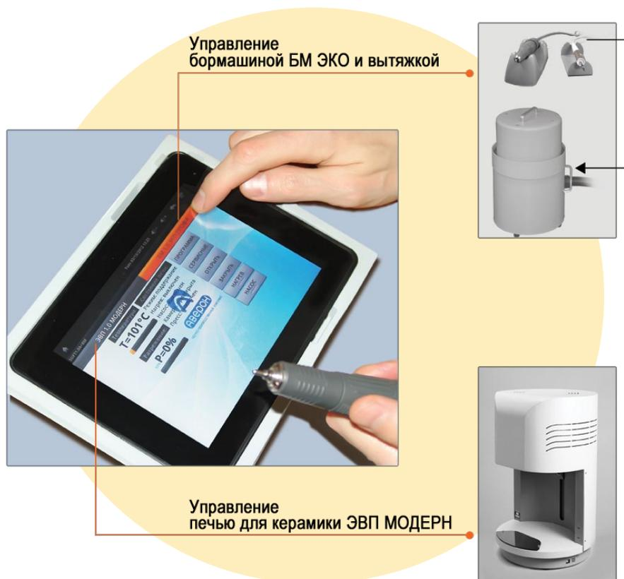
Программа позволяет с одного компьютера управлять печью ЭВП МОДЕРН и устройством БМ ЭКО ПРОФИ, в которое входят электрошпатель и синхронизированная с вытяжкой бормашина
