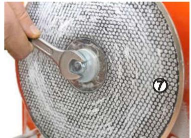
Если после замены диска на модели обнаружены борозды – провести правку поверхности диска металлической пластиной из нержавеющей или инструментальной стали толщиной не менее 1 мм. Общее время правки зависит от состояния поверхности, но не должно превышать 10 сек между повторами, с последующей проверкой результата на гипсовой модели.
